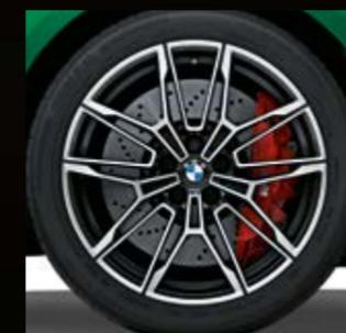
1T7 19" M Schmiederäder Doppelspeiche 825 M, Orbitgrau matt, glanzgedreht<sup>1</sup> Alternativ in Jetblack, glanzgedreht (1T6)
